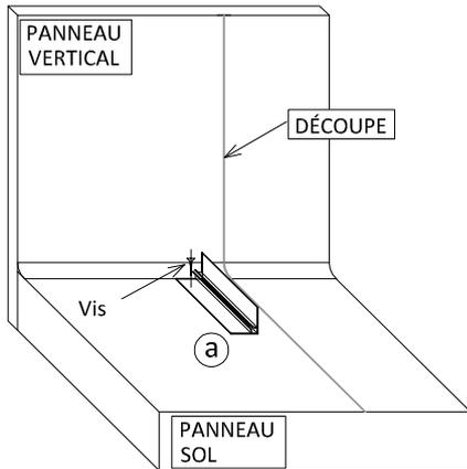
**1** RUPTURE DU PONT THERMIQUE: FAIRE UNE DÉCOUPE DE LA TÔLE INTÉRIEURE DU PANNEAU (SOL, PLAFOND ET VERTICAL) ET PLACER EL PANNEAU DIVISION SUR CETTE DÉCOUPE.
