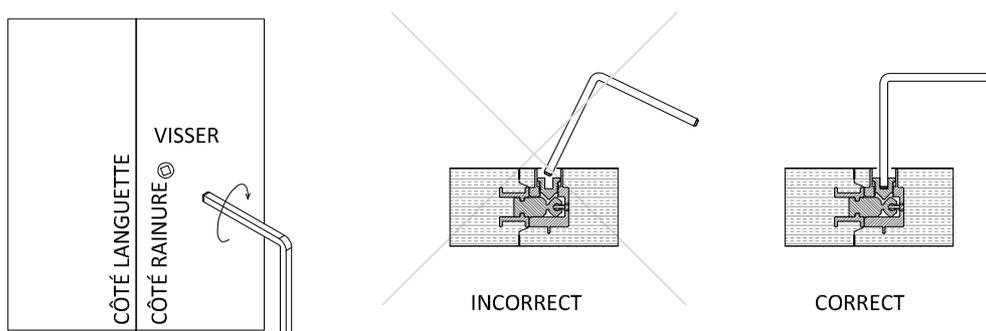
VISSER LA VIS GRÂCE À LA CLÉ FOURNIE DANS LE KIT DE MONTAGE POUR FIXER DÉFINITIVEMENT LES PANNEAUX.
