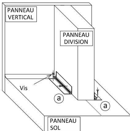
**3** PLACER LES PANNEAUX DIVISIONS CONTRE LE PROFIL QUI EST VISSÉ, ET POSTÉRIEUREMENT FIXER LA DIVISION EN LA VISSANT AU PROFIL. LES VIS SE PLACERONT DE FAÇON ALTERNÉE À CELLES PLACÉES SELON LE POINT 2.
